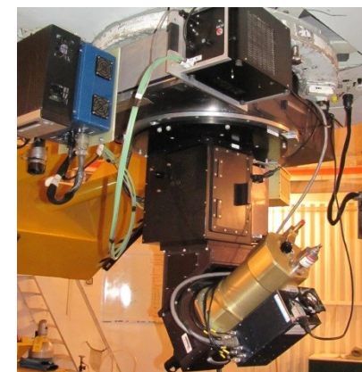
SPOL (米国Steward Obs. MMT6.5m/2m/1m) 偏光分光専用 G. Schmidt
