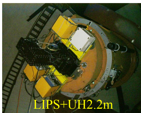
LIPS 直線偏光 + 中分散 ( R \sim 9000 ) エシエル分光器 (UH2.2m → 京産大1.3m)
