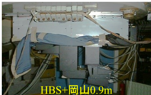
HBS 低分散 ( R \sim 100 ) 直線偏光分光専用装置 (堂平0.9m → 岡山0.9m/1.88m)
